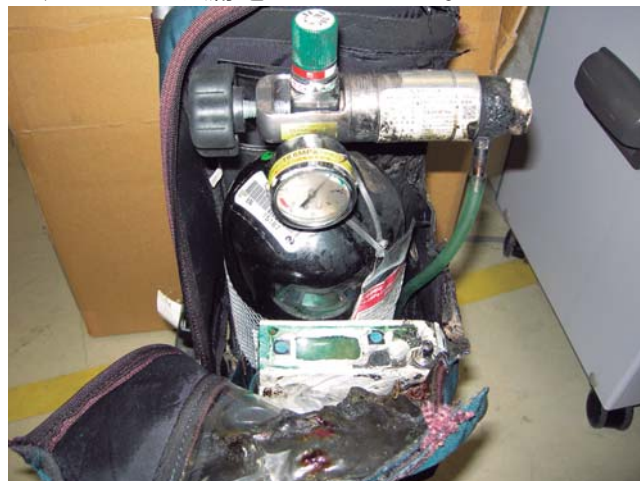
外で火を使う作業中に携帯酸素に引火した例(平成21年)
